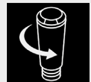
Filter aus Wasser- tank herausdrehen
